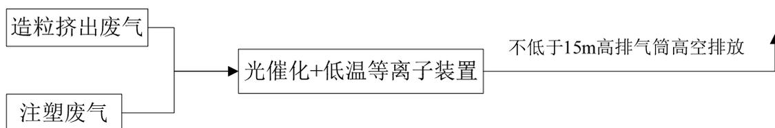
图 7-1 废气处理工艺流程图
